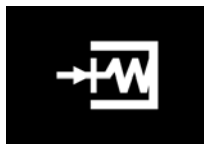
Рисунок 62: Индикатор «Включающая пружина натянута»
