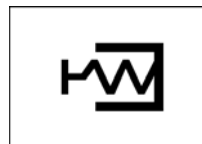
Рисунок 63: Индикатор «Включающая пружина не натянута»
